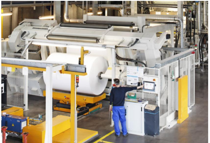
**Effizient** Die Rollen haben nach der Beschichtung eine Temperatur von etwa 30 Grad. Sie werden in Zukunft genutzt, um das Lager zu heizen.
